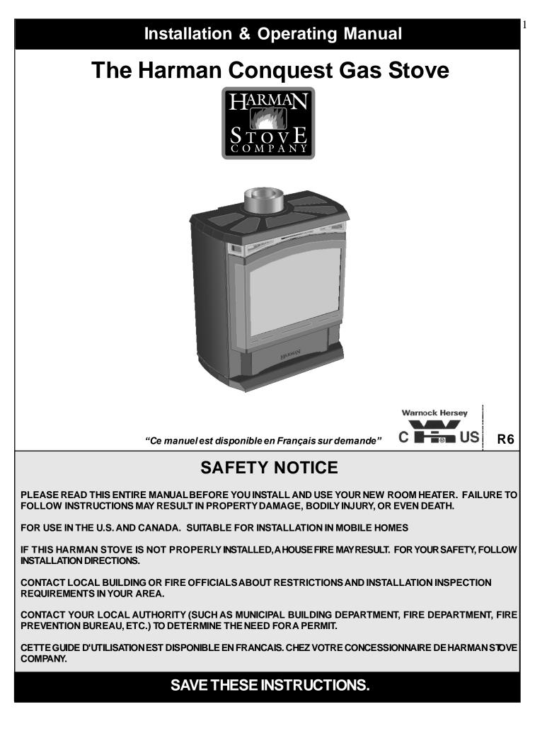
This appliance must be installed in accordance with local codes, if any, if not; follow the current edition of the National Fuel Gas Code, ANSI Z223.1 or Canadian Installation Codes, CAN/CGA B149. (Installer l'appareil selon les codes ou règlements locaux, ou, en l'absence de tels règlements, selon les Codes d'installation CAN/CGA-B149)
